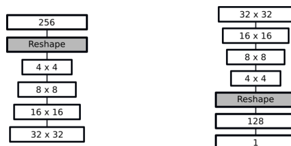
Figura 4.9. Arquitectura del Generador (izquierda) y Discriminador (derecha) para la generación de iconos
